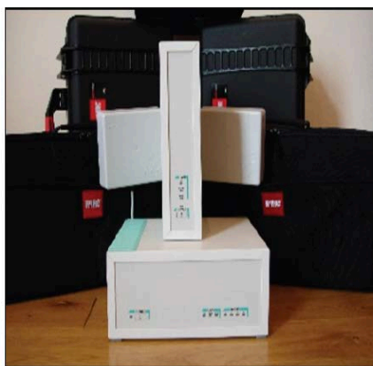
Figur 49 Det russiskproduserte mobilovervåkingsutstyret "White Russian".
