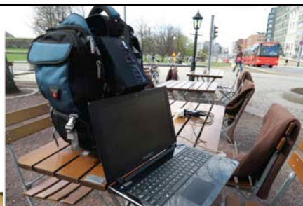
Figur 2 Fra Delma-måling ved Skansen i Oslo i april 2015. Utstyret får plass i en sekk, og består av en måleenhet, ant og en laptop.
